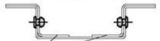
Стыковочный элемент из обрезков Z-профиля
